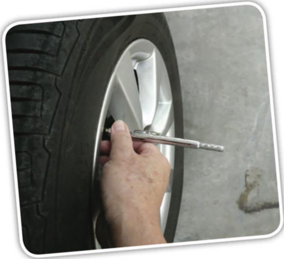
Gambar foto 4.6 Tekanan udara tayar kereta diukur
