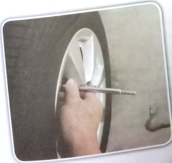
Gambar foto 4.6 Tekanan udara tayar kereta diukur
